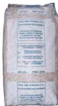
**Nous utilisons le gravier en tant que couches supports dans les filtres à média (sable, charbon actif...) et les échangeurs sur résines.**
