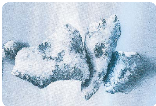
Grain de Filter-Ag (silicate d'alumine non hydratée)
